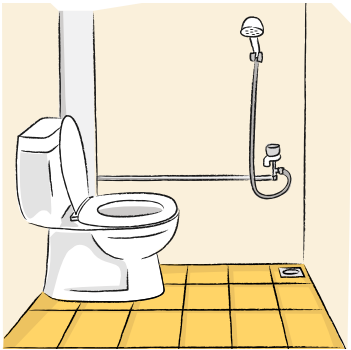
改装后： 用水泥将下凹的淋浴区填平至与厕所地面相同的高度
