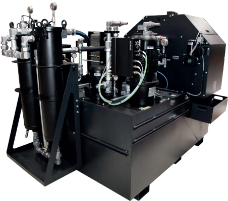
Bandfilter Geteilt in zwei Tankeinheiten, Reintank und Reinsttank mit großvolumigem Fassungsvermögen von 1700 Litern.
