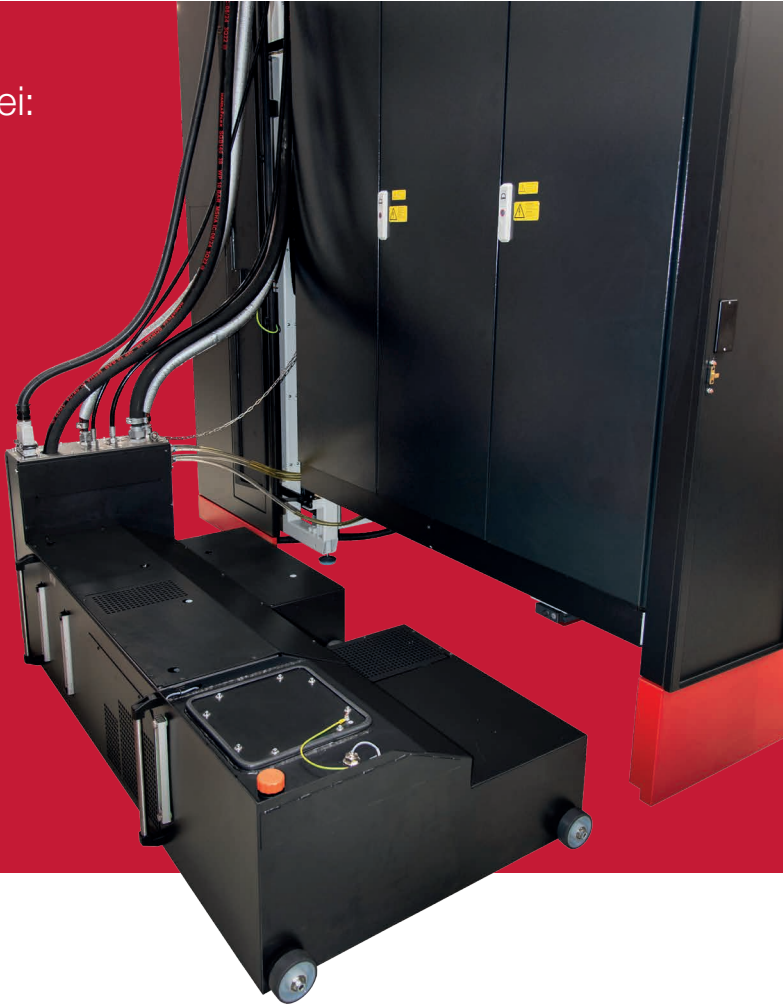
Hybridaggregat Maximale Bearbeitungsqualität und Kompaktheit durch das vollintegrierte Hybridaggregat, welches unter anderem das erweiterte Kern Temperaturmanagement versorgt.
