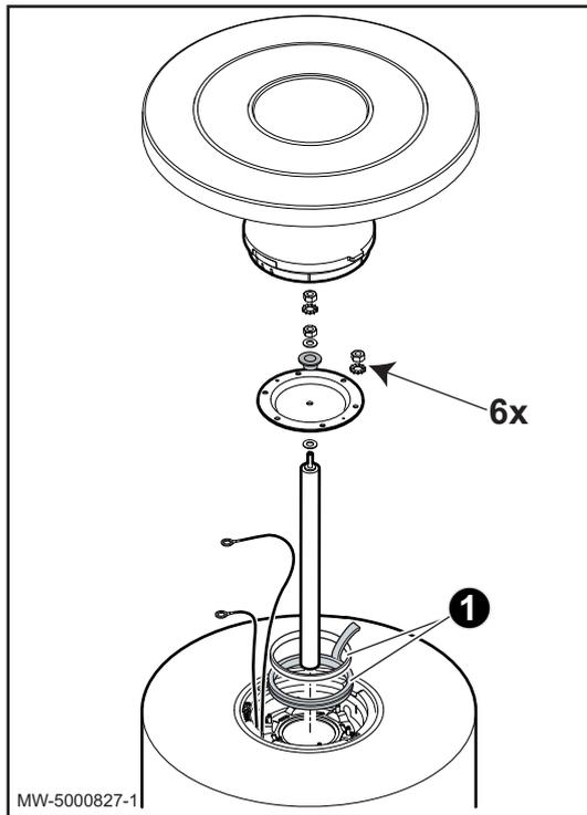
1. Cambiar el conjunto de la junta con reborde y la arandela y colocarlo en el orificio de inspección procurando dejar la lengüeta de la junta con reborde fuera del acumulador de agua caliente sanitaria.
