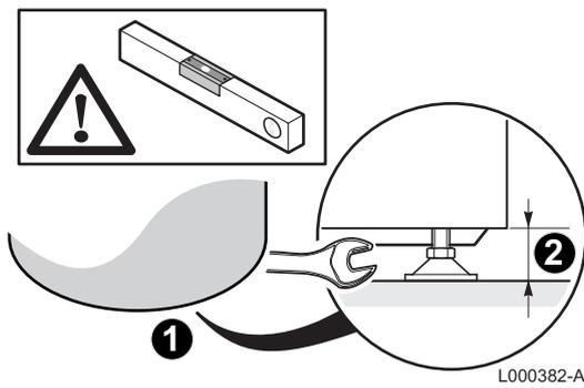
1. Atornillar los tres pies ajustables en la parte inferior del acumulador de agua caliente sanitaria.
