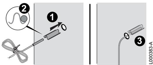
1. Colocar la sonda en la vaina mediante el separador.
