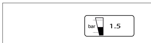
Fig. 57 Pressão do sistema apresentada no ecrã
