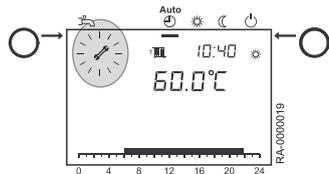
Si la señal de mantenimiento aparece en la pantalla
