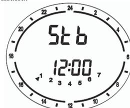
**Atención:** en esta posición, de todos modos, el radiador es alimentado eléctricamente.
