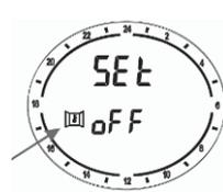
**Nota:** el correcto funcionamiento de esta función está influenciado por la posición del radiador. Si el radiador está en una posición tal que no permite detectar la disminución de la temperatura o en la que se ve afectada por la presencia de otras fuentes de calor, es posible que no se detecte la apertura de la ventana.
