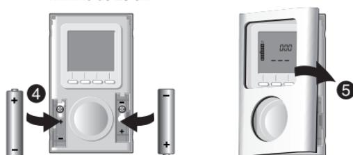
Uma vez que a sonda de medição da temperatura está dentro da caixa, deve colocar o termóstato:
