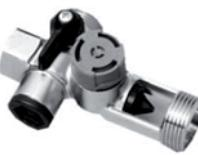
Los grupos de seguridad pueden producir frecuentes descargas en función del aumento de la presión en el circuito secundario, por lo que debe de canalizarse su orificio de descarga, tal y como lo exige la normativa. No obstante, si se quiere evitar este normal goteo, recomendamos la colocación de un depósito de expansión (VASOFLEX/S) para Agua Caliente Sanitaria entre el acumulador y el grupo FLEXBRANE.
