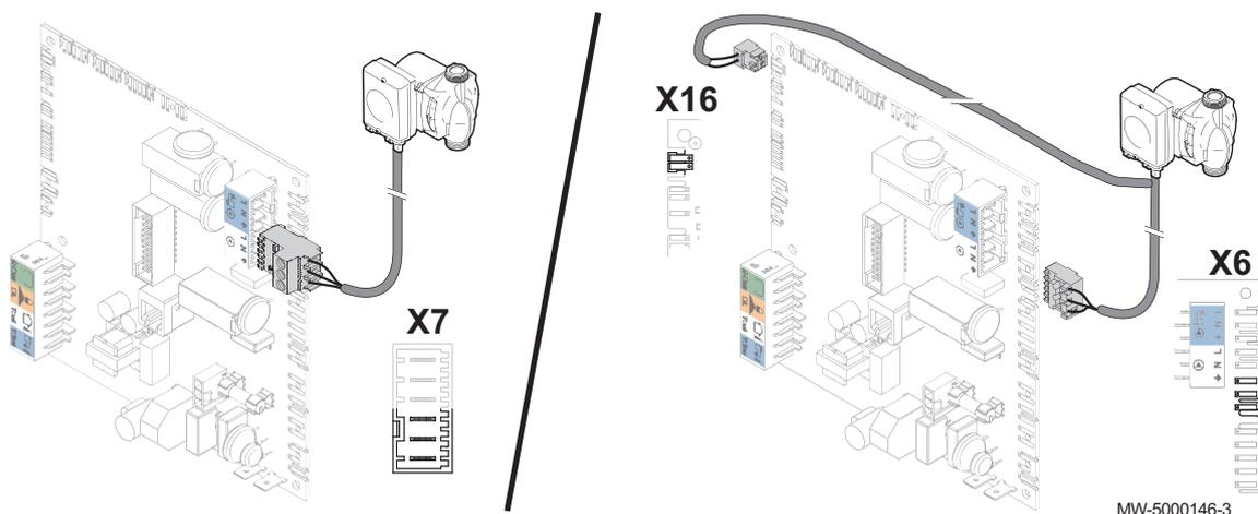
1. Ligar a bomba de aquecimento de circuito direto de acordo com o tipo e a configuração da instalação.
