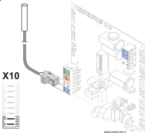
1. Ligar a sonda da temperatura da água quente sanitária à entrada **Tdhw** na placa eletrônica principal **CU-OH04**.
