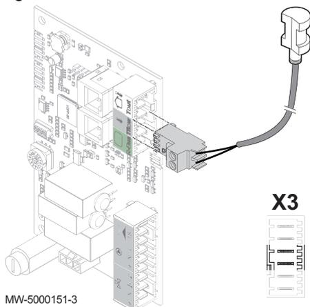
1. Ligar a sonda da temperatura à entrada **X3 S DEP** na placa eletrônica **SCB-04** opcional.
