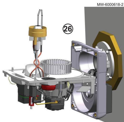
26. Limpar o ventilador e o interior da caixa de sucção utilizando uma escova adequada e ar comprimido.
