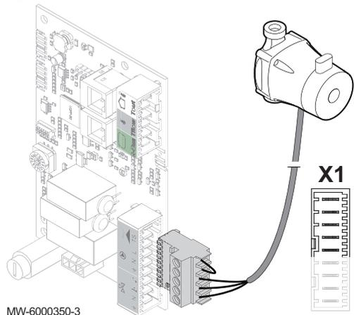
1. Ligar a bomba de aquecimento de circuito misto à entrada X1 na placa eletrónica SCB-04 opcional.
