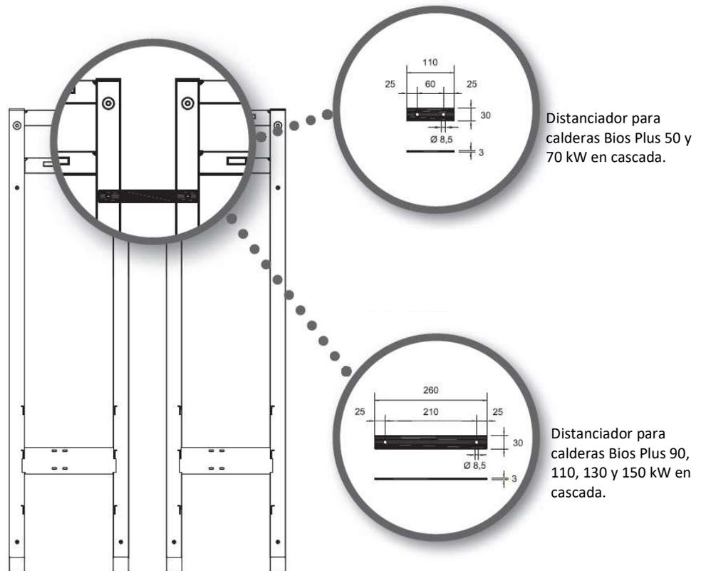
Instalación en cascada de las Bios Plus 50 y 70 kW:
