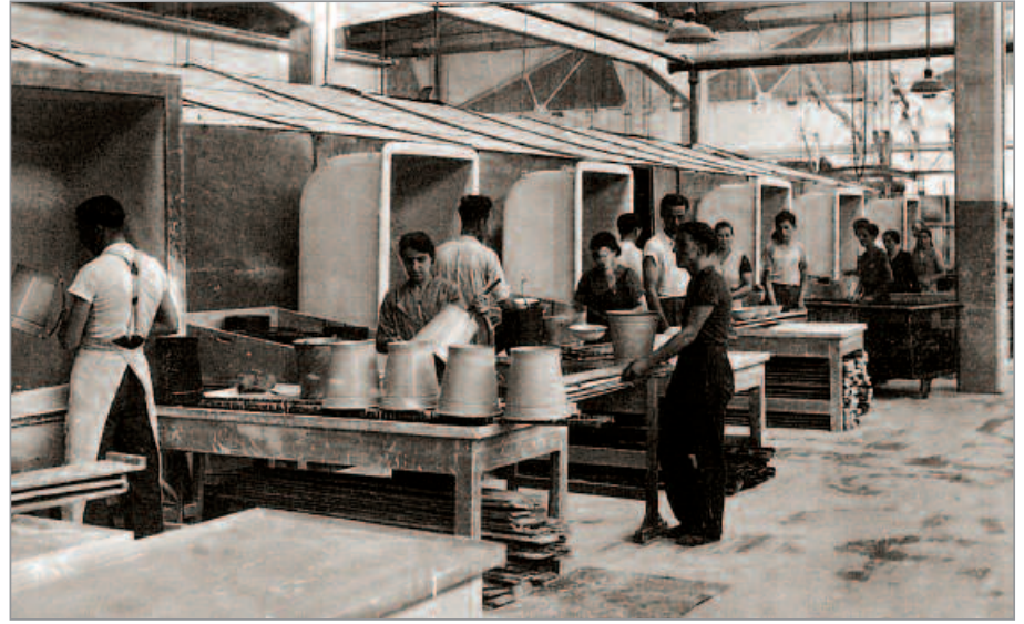
Da sinistra verso destra La verniciatura dei radiatori per trasformatori (anni '50-'60). La smaltatura delle vasche da bagno nel 1960.
