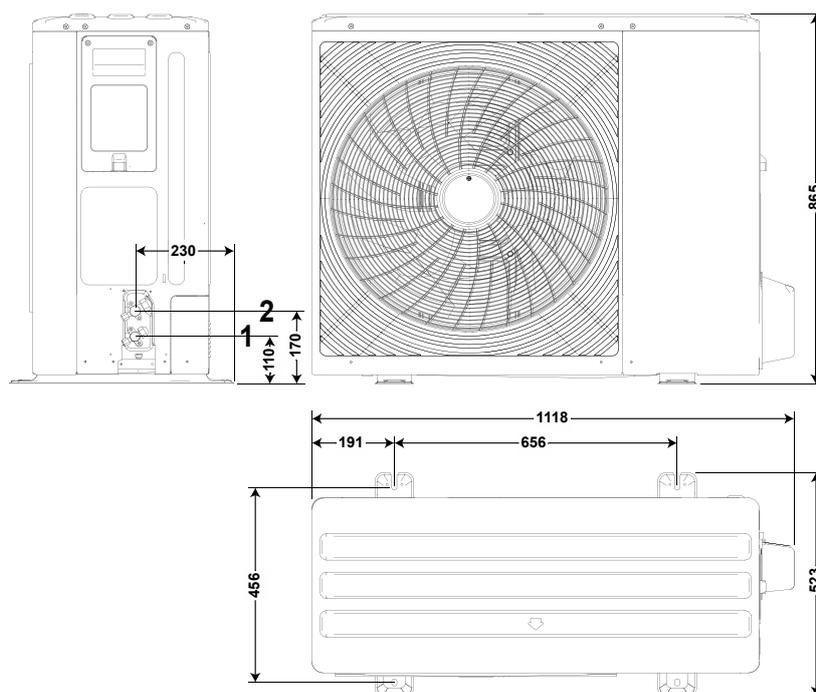
1. Collegamento del refrigerante da 3/8" - linea liquido    2. Collegamento del refrigerante da 5/8" - linea gas
