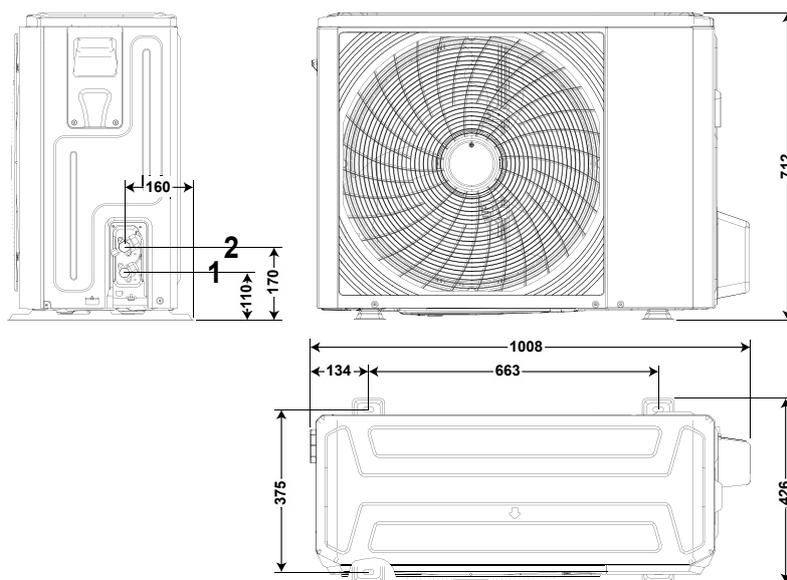
1. Collegamento del refrigerante da 1/4" - linea del liquido    2. Collegamento del refrigerante da 5/8" - linea gas
