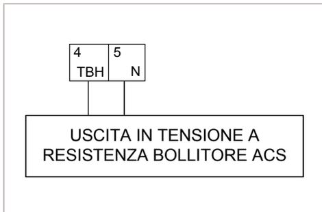
Il controllo elettronico della pompa di calore Auriga permette di gestire una fonte ausiliaria installata sul bollitore di ACS (TBH) mediante contatto in morsettiera. La logica di funzionamento prevede l'attivazione della fonte ausiliaria in base a:
