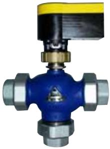
La valvola a 3 vie consente di deviare il flusso idraulico su un serpentino per caricare il bollitore di ACS. L'elettronica gestisce la temperatura del bollitore dal pannello di controllo. La sonda (fornita DI SERIE), si collega nella scheda principale al terminale T5 e la valvola viene alimentata direttamente dall'unità nella morsettiera principale ai terminali 6, 7 e 21.
