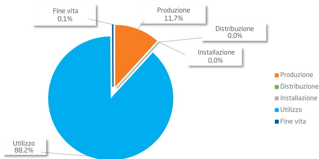
L'impatto principale sull'ambiente è legato alla fase di utilizzo del prodotto (88,2%) e pertanto Baxi ha deciso di porre attenzione a questa fase utilizzando come gas di funzionamento, una **miscela funzionante con 20% di idrogeno verde** che determina una **riduzione delle emissioni di CO<sub>2</sub> del 7% rispetto al funzionamento con gas metano**.
