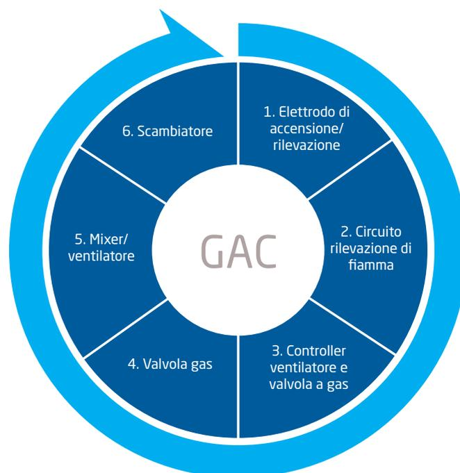
Il sistema misura continuamente il segnale di fiamma durante il funzionamento della caldaia e aggiusta la portata di gas in modo da mantenere costante la qualità della combustione e tutto questo senza che sia richiesto alcun componente aggiuntivo all'interno della camera di combustione.
