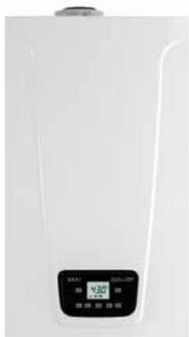
La caldaia a condensazione da 24 kW (28 kW per la versione con pdc da 11 kW) è caratterizzata da un **campo di modulazione 1:7** che determina una maggiore efficienza data da minori accensioni e spegnimenti: con un rapporto di modulazione elevato la **riduzione dei continui cicli di on/off** comporta una significativa riduzione dei consumi (dell'8-10%) e una pari riduzione delle emissioni inquinanti e una **maggiore silenziosità in ambiente per l'utente**.
