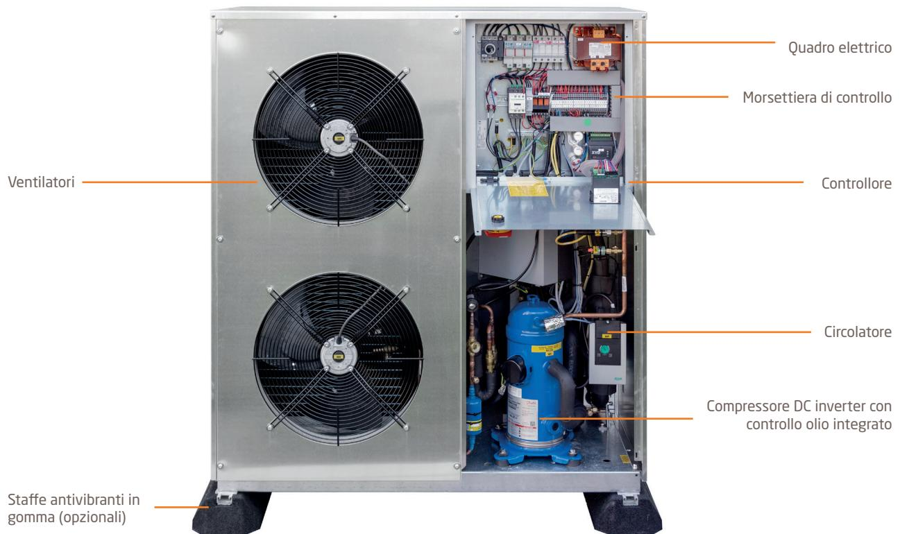
**Compressore scroll DC inverter:** completo di protezione termica interna, resistenza carter, spia per il controllo dell'olio, montato su gommini antivibranti per ridurre le vibrazioni.
