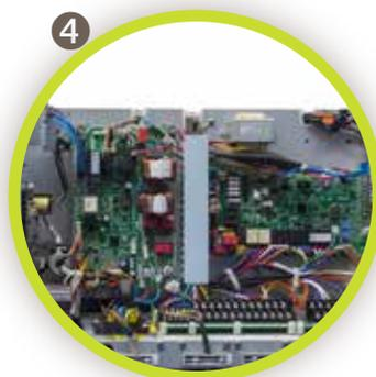
Quadro elettrico: include la protezione tramite fusibili dei principali componenti interni; la morsettiera è divisa in una sezione di potenza per l'alimentazione dell'unità ed una morsettiera di controllo per il collegamento di ingressi/uscite ausiliarie e il collegamento al pannello di comando.
