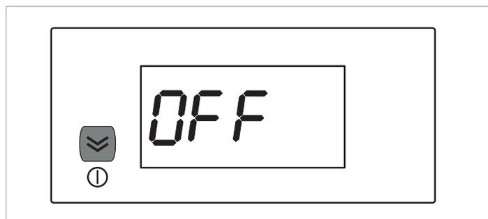
Nella condizione di OFF dell'unità è possibile comunque accedere ad alcuni parametri mediante il tasto SET.
