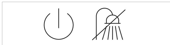
▲ Il comando di **STANDBY** ha priorità sulla chiamata DHW, ciò significa che con unità in STANDBY la funzione DHW non è attiva.
