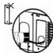
**Uscita posteriore:** togliere il rivestimento di gomma dal sostegno del tubo vicino alla copertura interna del tubo di uscita dell'apparecchio.
