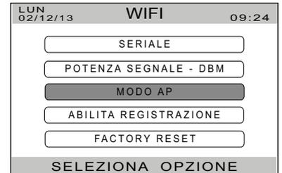
Sulla pagina principale del controllo remoto si visualizza la sigla AP per indicare l'attivazione della procedura. Il MODO AP ha un limite temporale di attivazione, superato il quale, nel caso in cui la procedura non vada a buon fine, il controllo remoto tornerà al normale funzionamento.
