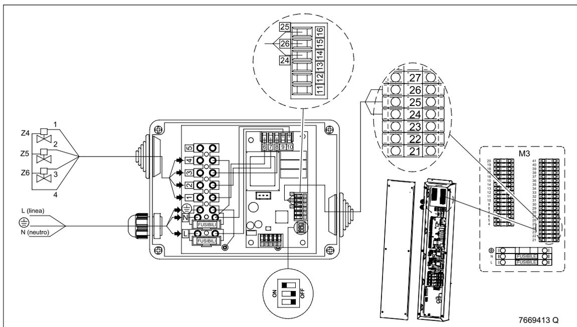
Questa configurazione consente di gestire un impianto di riscaldamento con massimo 6 sottozone (3 sottozone sono gestite dal sistema e 3 sottozone sono gestite dal modulo di estensione). Settare il dip switch come indicato nella figura.
