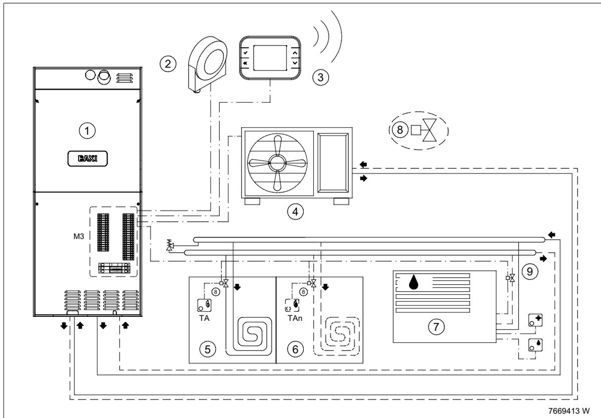
Il sistema è in grado di gestire un circuito di raffrescamento/riscaldamento comandato da TA. Il Controllo Remoto deve essere utilizzato come programmatore dell'impianto di raffrescamento / riscaldamento. In fase di prima accensione (vedere capitolo "PRIMA ACCENSIONE DEL SISTEMA") non impostare la presenza di sensori ambiente.
