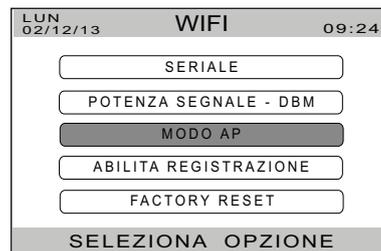
Sulla pagina principale del controllo remoto si visualizza la sigla AP per indicare l'attivazione della procedura. Il MODO AP ha un limite temporale di attivazione, superato il quale, nel caso in cui la procedura non vada a buon fine, il controllo remoto tornerà al normale funzionamento.
