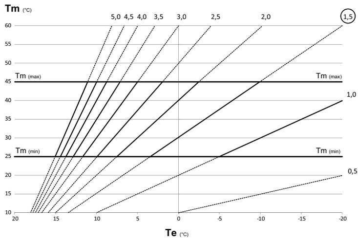
**CURVE SONDA ESTERNA CON RICHIESTA DI CALORE DA TERMOSTATO AMBIENTE**
