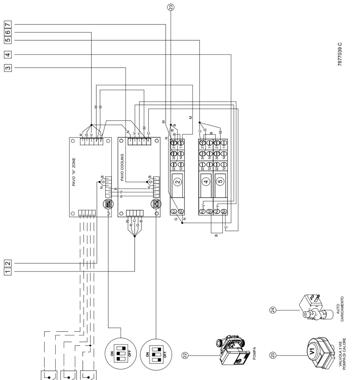
Termostato ambiente + Micro fine corsa su valvole di zone
