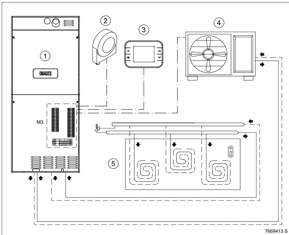
Il sistema fornito è predisposto per la gestione di un circuito in bassa temperatura gestito dal Controllo Remoto. Il Controllo Remoto deve essere utilizzato come programmatore dell'impianto di riscaldamento.
