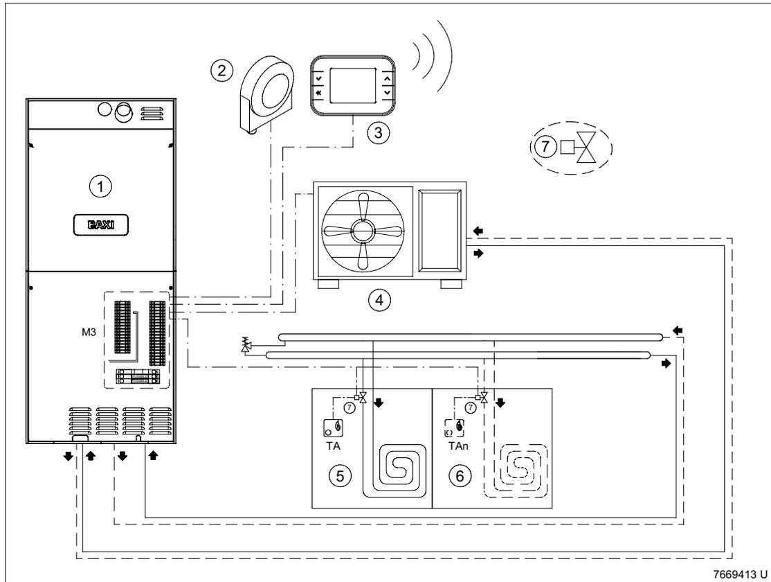
Il sistema gestisce la distribuzione del calore in sottozone utilizzando valvole di zona che devono essere installate nel circuito idraulico. Le sottozone vengono gestite mediante "TA".
