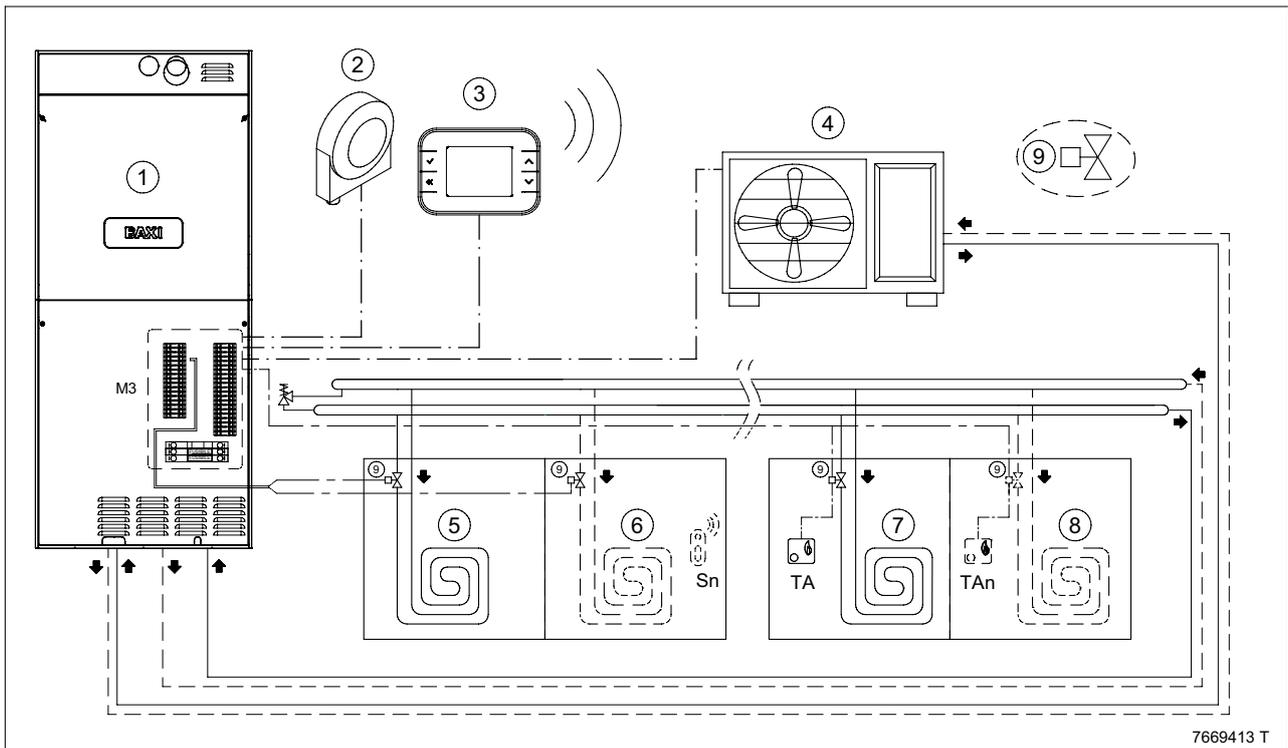
Il sistema gestisce la distribuzione del calore in sottozone utilizzando valvole di zona che devono essere installate nel circuito idraulico. Si possono gestire fino a 8 sottozone mediante sonde wireless (S) e ulteriori sottozone utilizzando termostati ambiente (TA).
