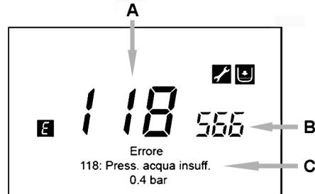
Le anomalie visualizzate sul display sono identificate dal simbolo E, le informazioni visualizzate sul display sono:
