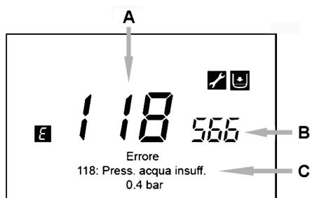
В случае возникновения неисправности на дисплее высвечивается символ **E**, рядом с которым отображается следующая информация:
