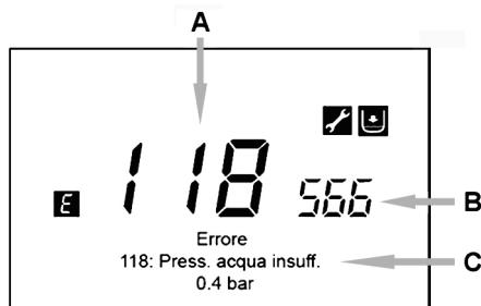
Anomaliiile de funcționare afișate pe display sunt identificate prin simbolul **E**. Pe display sunt afișate următoarele informații:
