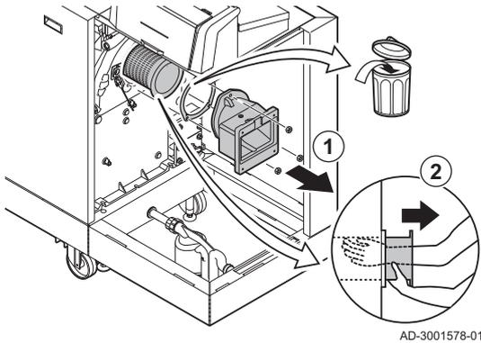
1. Die Schrauben aus dem Adapter herausdrehen und den Adapter ausbauen.
