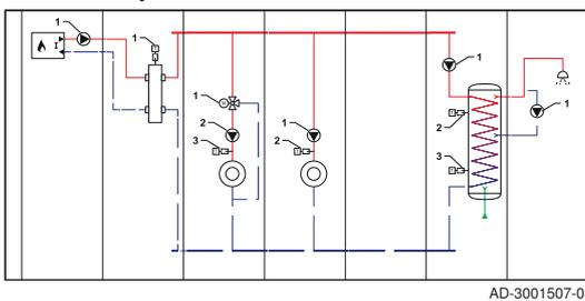
Hydraulische Anschlüsse: Es sind nur die wesentlichen Teile dargestellt, die mit einer Leiterplatte zu verbindenden Teile sind nummeriert.
