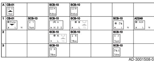
Elektrische Anschlüsse: Die Nummern in den hydraulischen Anschlüssen beziehen sich auf die Stecker in dieser Reihe. Die Art des Anschlusses wird mit mehreren Ziffern gekennzeichnet:
