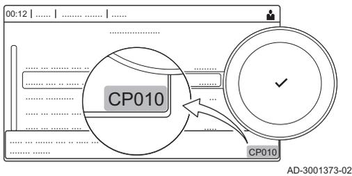
Die Steuerungsplattform nutzt ein erweitertes System zur Kategorisierung von Parametern, Messungen und Zählern. Wenn man die Logik hinter diesen Codes kennt, ist es einfacher, sie zu identifizieren. Der Code besteht aus zwei Buchstaben und drei Zahlen.
