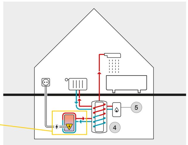
Heizkreislafs abgegeben. Im Pufferspeicher **4** kann es zwischengespeichert werden. In Spitzenlastzeiten unterstützt ein Gas-Brennwertgerät **5** das System.
