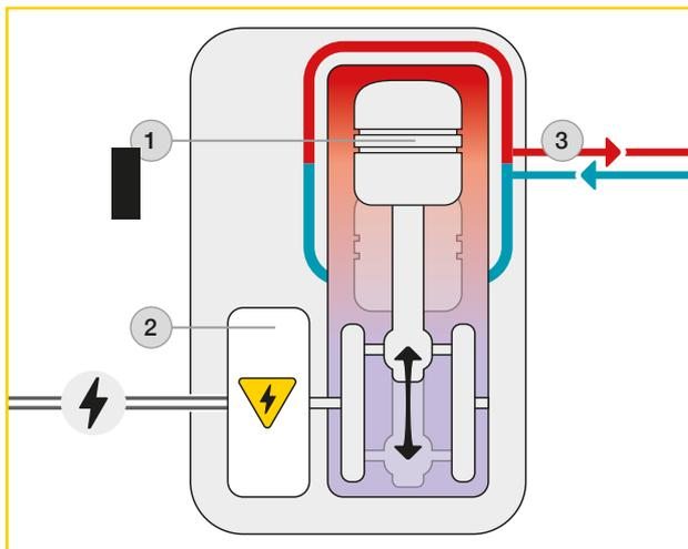
Im BHKW treibt ein Verbrennungsmotor **1** einen Generator **2** an, in dem Strom erzeugt wird. Die dabei entstehende (Ab-)Wärme **3** wird über Wärmetauscher gewandelt und an das Wasser des
