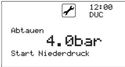
Der eingestellte Niederdruckwert bzw. die eingestellte Temperaturdifferenz benennt den Betriebspunkt, ab wann die Abtaung beginnen soll. Der Betriebspunkt muss mindestens für die eingestellte Kontrollzeit anliegen, um die Abtaubedingung zu erfüllen.
