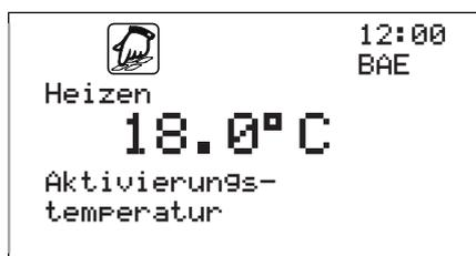
Die Aktivierungstemperatur gibt an, ab welcher Außentemperatur die Funktion Heizen bzw. Kühlen verfügbar ist in Abhängig von dem Aktivierungszeitraum.
