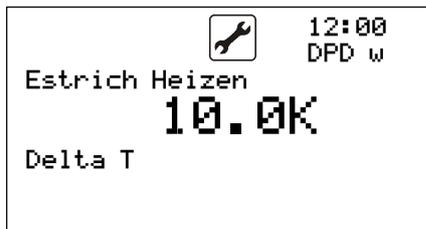
Einstellen der Temperaturstufen Delta T pro Schritt.
