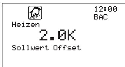
Sollwert Offset dient zur Berechnung des Ein- und Ausschaltpunktes in Bezug auf eine Anforderung in Heiz- bzw. Kühlfall. Eine Anforderung gilt als beendet, wenn der Istwert größer gleich Sollwert plus Sollwert Offset ist. Eine Anforderung wird ausgelöst, wenn der Istwert kleiner gleich Sollwert minus Sollwert Offset ist.
