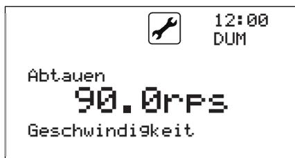
Die Geschwindigkeit gibt an, mit welcher max. Geschwindigkeit der Abtauzyklus gefahren werden darf.
