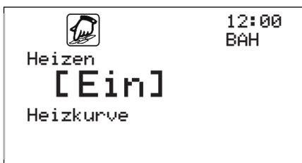
Die Heiz- bzw. Kühlkurve beschreibt die Anpassung der Vorlauftemperatur an die aktuelle Regelungstemperaturgröße (Außentemperatur oder Referenzraumtemperatur) Mit deaktivierter Kurve wird ein Festwert genutzt.
