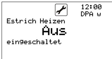
Nach Ende des Aufheizprogramms hier wieder auf „aus“ stellen. Sonst läuft nur ein Frostsicherungsprogramm.
