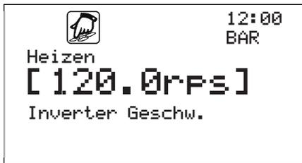
Die Inverter-Geschwindigkeit legt fest, mit welcher maximalen Drehzahl die Funktion ausgeführt werden kann. Hierdurch wird auch eine Leistungsbegrenzung erreicht.
