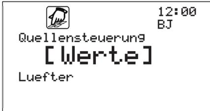
Die Quellensteuerung ist in Abhängigkeit zum Maschinentyp angepasst und unterscheidet die Quellensteuerung bei verschiedenen Funktionen bzw. Arbeitsmodi. Hier Typ 1 mit Lüfter.
