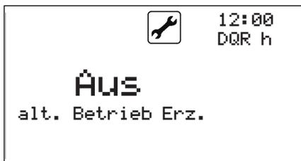
Wenn zwei, drei oder vier Verdichter als Erzeuger arbeiten, kann hier eine alternierende Ansteuerung eingeschaltet werden. Dann wird bei jedem neuen einschalten anhand der Betriebsstunden überprüft, welcher Erzeuger als erstes eingeschaltet werden soll.
