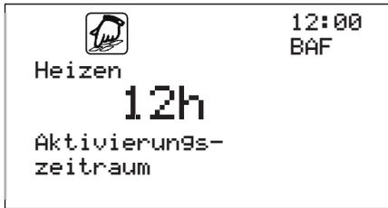
Der Aktivierungszeitraum gibt an, wie lange die Außentemperatur dauerhaft vorliegen muss, um die Funktion Heizen bzw. Kühlen freizugeben.
