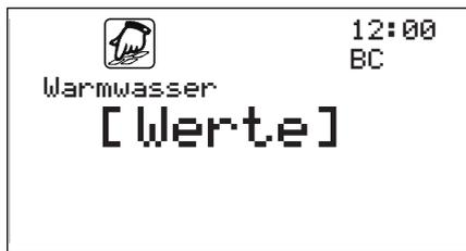
Die Warmwasser-Programmierung erfolgt mit Ausnahme der Heizkurve, da hier ein Festwert zugrunde liegt, genau wie bei der Programmierung bei Heizen oder Kühlen.
