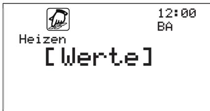
Das Untermenü Heizen erlaubt die Programmierung für die Funktionen im Heizbetrieb. Bestimmte Einstellungen lassen sich nur mit den entsprechenden Rechten ändern. Eine vorherige Passworteingabe ist notwendig. Der Umfang der Einstellmöglichkeiten entspricht dem gleichen Maße wie beim Kühlen.
