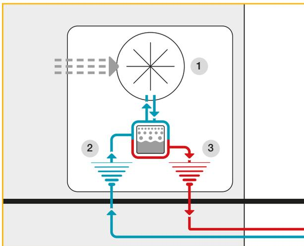
Luft-Wasser-Wärmepumpen gewinnen ihre Wärme aus der Umgebungsluft. Der Ventilator der Außeneinheit 1 saugt Luft ein. Die enthaltene Energie wird auf ein Kältemittel 2 übertragen, das dadurch verdampft. Der Dampf erhitzt sich in einem
