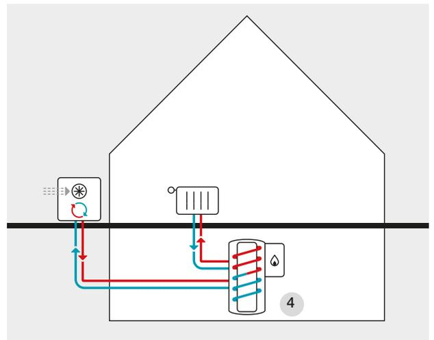
Verdichter 3 unter hohem Druck und gibt seine Energie danach in einem Verflüssiger 4 an das Wasser des Heizkreislaufs ab. Auf diese Art lassen sich bei der **Elga Ace** aus 1 kWh Strom bis zu 4,54 kWh Wärmeenergie gewinnen (= COP 4,54).
