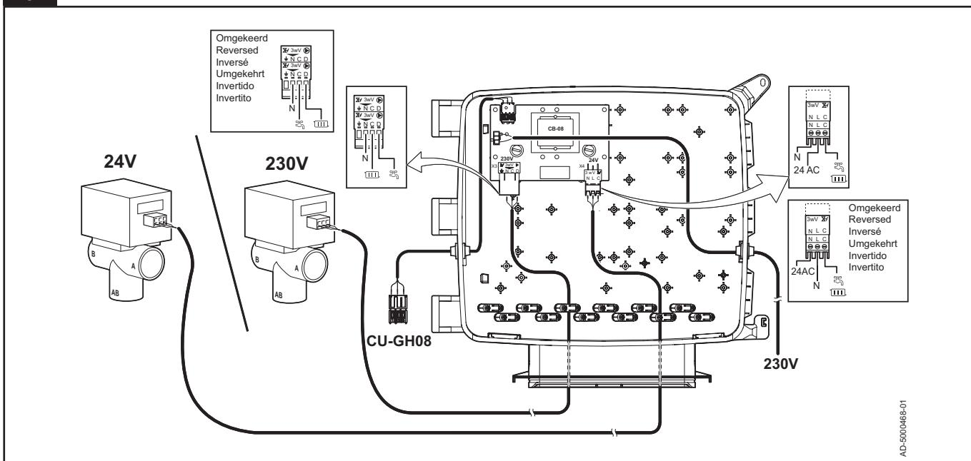
Om de draairichting van de **24V**-klep om te draaien, verwisselt u de aansluitingen **N** en **L**.
