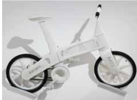
Das Speichendesign der Airbike-Räder ist an den Sichel-Propeller des Airbus-Transportflugzeugs A400M angelehnt.
