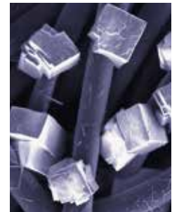
REM-Aufnahme der während der Zellentladung entstehenden, würfelförmigen \text{NaO}_2 -Partikel.
