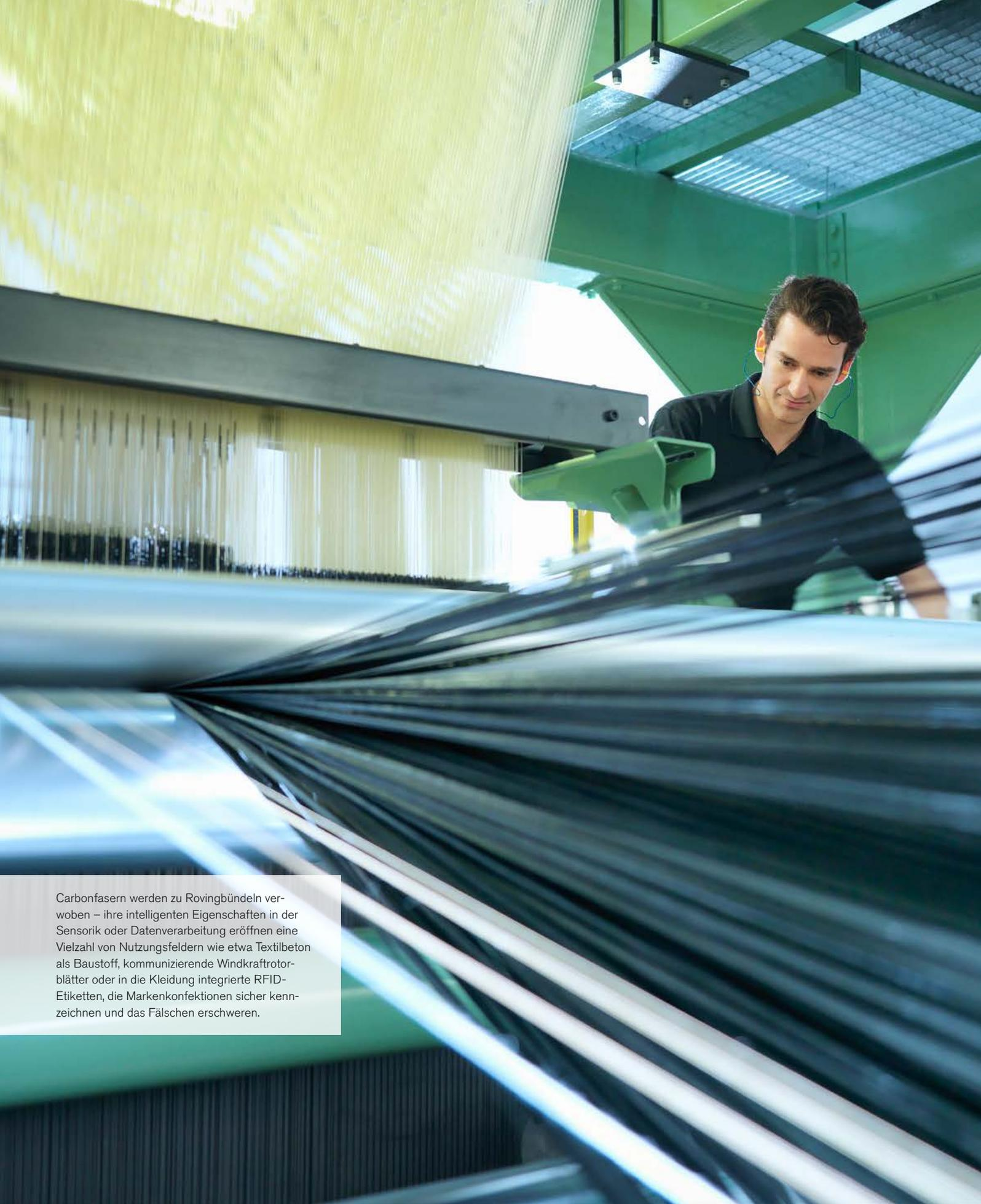
Carbonfasern werden zu Rovingbündeln verwoben – ihre intelligenten Eigenschaften in der Sensorik oder Datenverarbeitung eröffnen eine Vielzahl von Nutzungsfeldern wie etwa Textilbeton als Baustoff, kommunizierende Windkraftrotorblätter oder in die Kleidung integrierte RFID-Etiketten, die Markenkongfektionen sicher kennzeichnen und das Fälschen erschweren.
