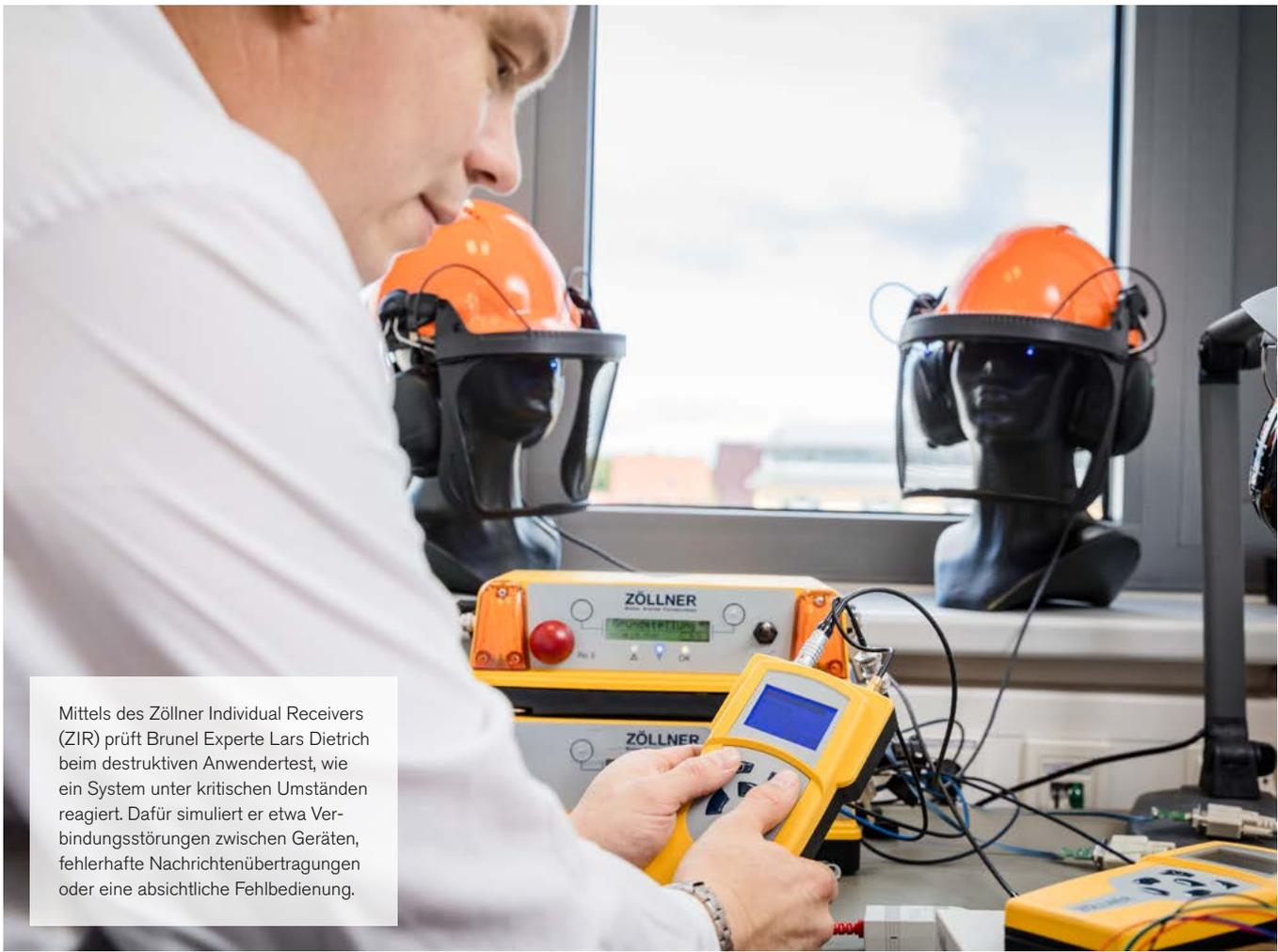
Mittels des Zöllner Individual Receivers (ZIR) prüft Brunel Experte Lars Dietrich beim destruktiven Anwendertest, wie ein System unter kritischen Umständen reagiert. Dafür simuliert er etwa Verbindungsstörungen zwischen Geräten, fehlerhafte Nachrichtenübertragungen oder eine absichtliche Fehlbedienung.
