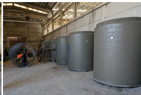
Elementos prefabricados para conducciones de saneamiento de secciones mixtas desplegados en la obra de Saneamiento y Depuración en Montijo-Puebla de la Calzada (Badajoz)
