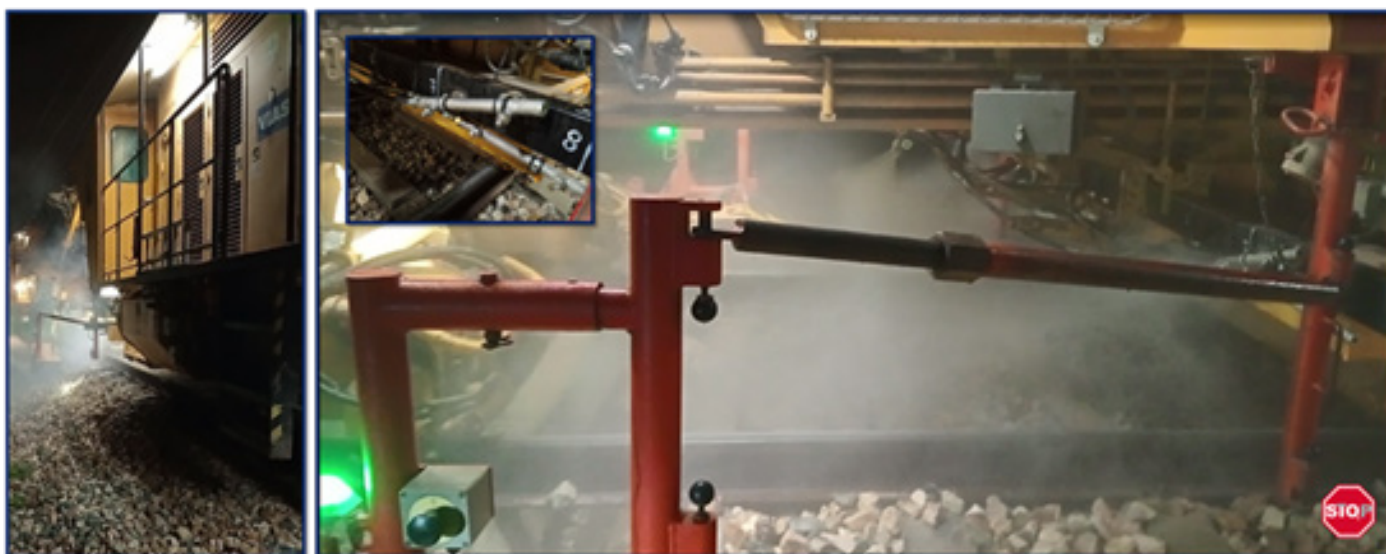
Pruebas de nebulizado con prototipo sobre desguarnecido
