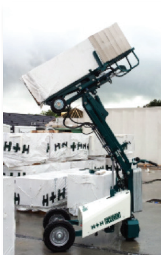
H+H R'GO kan også benyttes til højere løft af Multipladen®. Kippes stakkene til lodret position, er løftehøjden på den nederste del af blokgaflen 1,6m over gulv.
