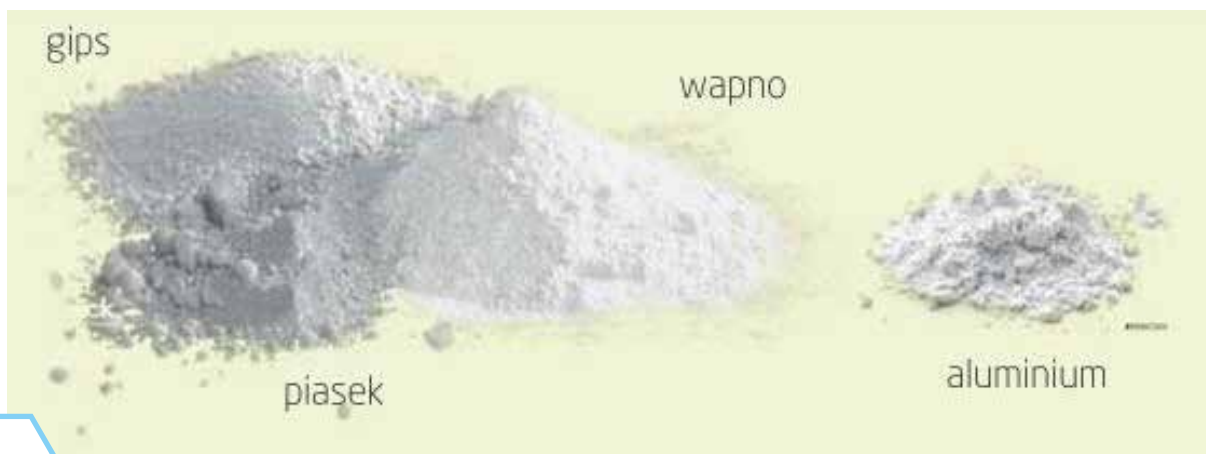
Ilustracja 2: Surowce betonu komórkowego
