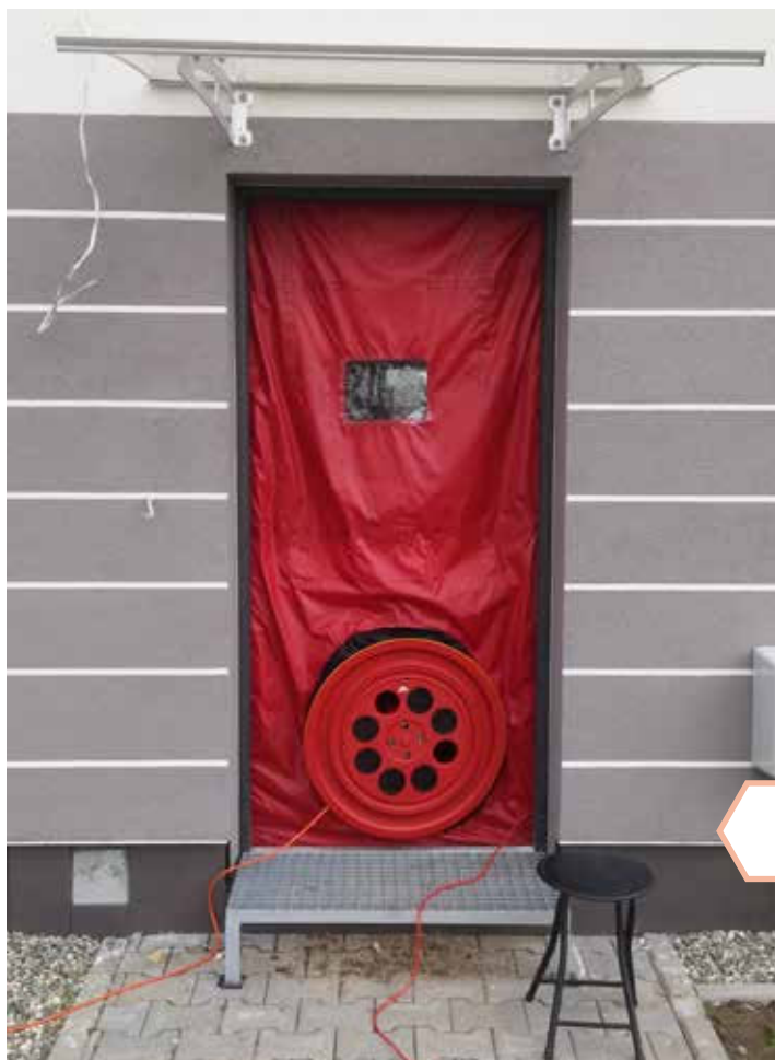
Rys. 2.3. Urządzenie do pomiaru szczelności powietrznej budynków.
