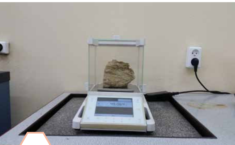
Rys. 5.2. Próbka izolacji termicznej o niewiel- kiej objętości w wagosuszarce
