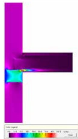
Rys. M22.1 Gęstość strumienia ciepła w przekroju modelu
