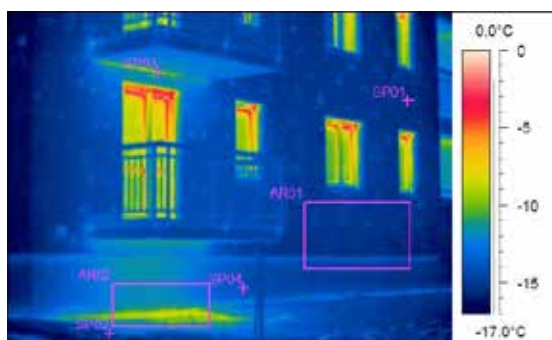
Rys. 4.2. Mostki termiczne w obrębie ściany szkieletowej [1].
