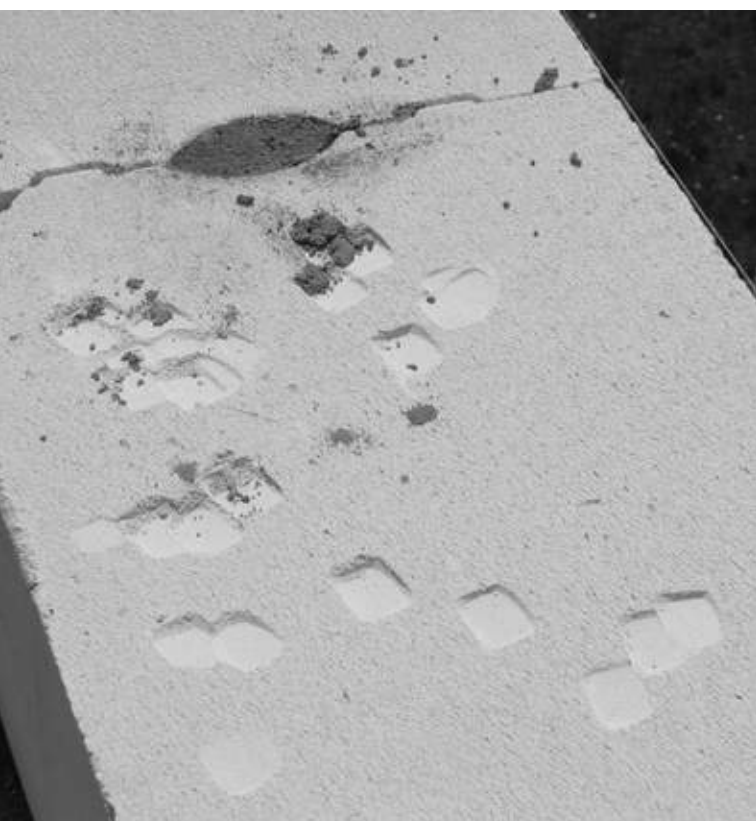
Ilustracja 6.1. Efekt zastosowania niewłaściwych narzędzi
