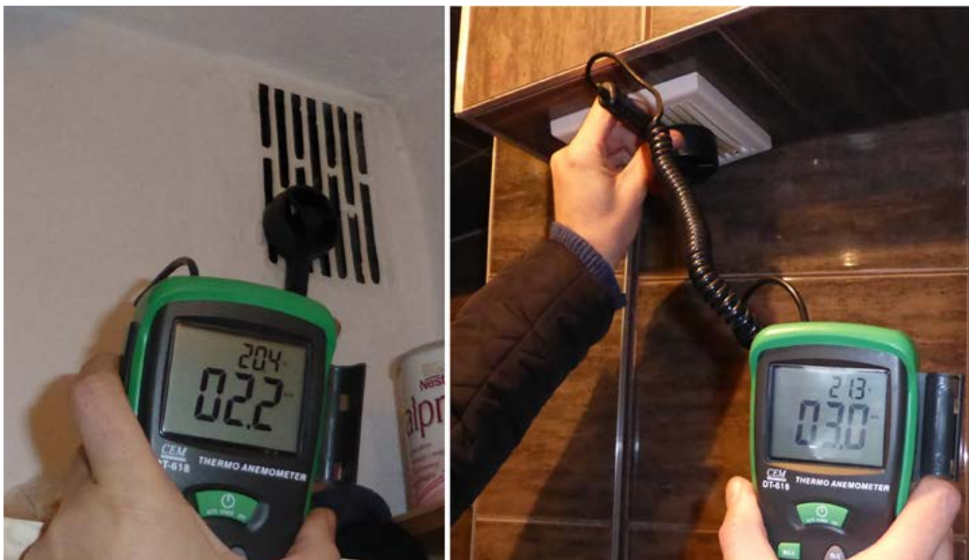
Rysunek 3. Pomiar przepływu powietrza w kratkach wentylacyjnych przy rozszczelnionych oknach (źródło własne Zjawia-
