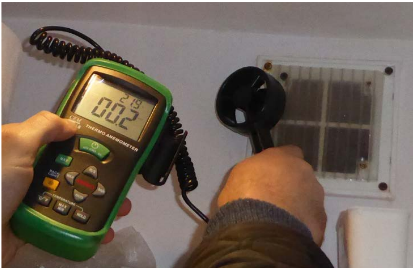
Rysunek 2. Pomiar przepływu powietrza w kratce wentylacyjnej przy zamkniętych oknach, wentylacja grawitacyjna (źródło własne)
