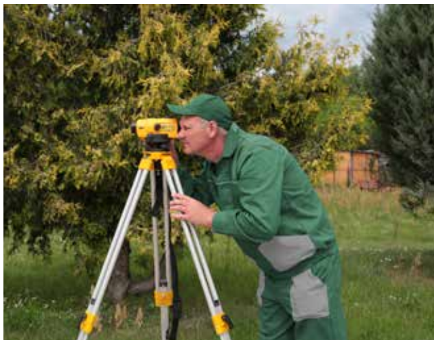
Fotografia 13. Do niwelacji punktów charakterystycznych budynku należy używać niwelatora
