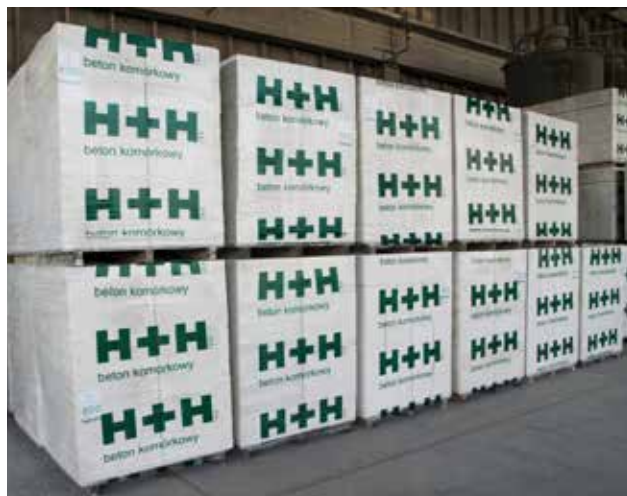
Fotografia 4. Palety z blockami z betonu komórkowego składowane maksymalnie na wysokość 2 warstw.
