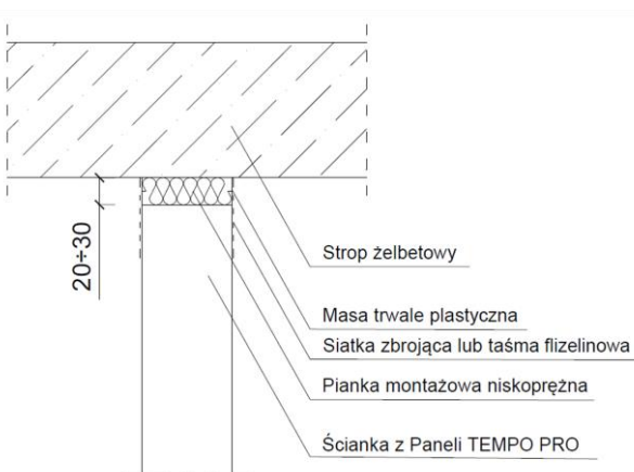
Rys. 3. Schemat wykonania wypełnienia szczeliny podstropowej.
