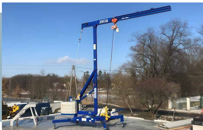
Rys. 7.2. Miniżuraw MK 240 do murowania ścian konstrukcyjnych, fot. Xella Polska
