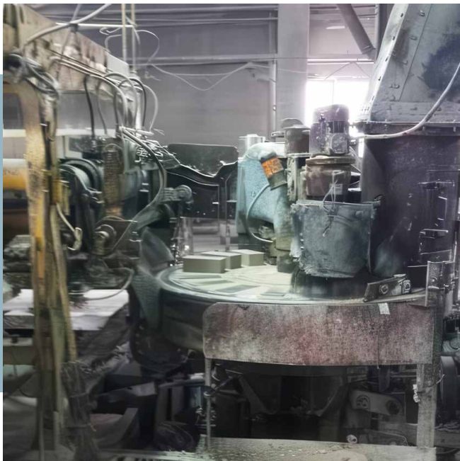
Rys. 2.4. Prasa ze stołem obrotowym 16-stemplowym PXC/250 z automatycznym odbiorem cegieł ze stołu prasy na przenośnik, fot. H+H Polska
