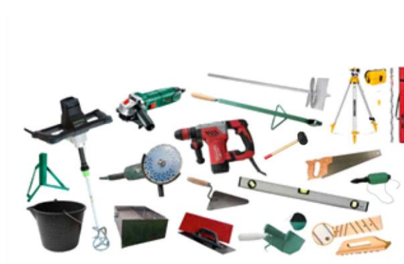
Fot. 2. Zestaw narzędzi używanych podczas montażu ścian z Paneli TEMPO PRO
