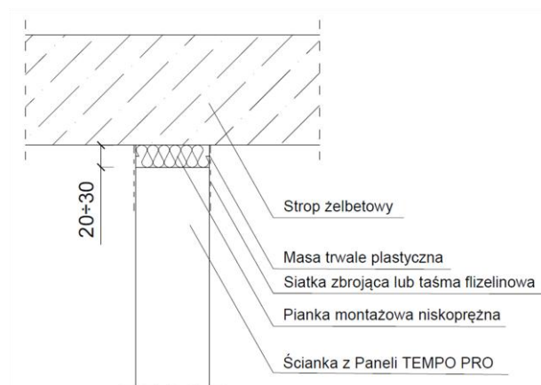
Rys. 3. Schemat wykonania wypełnienia szczeliny podstropowej.
