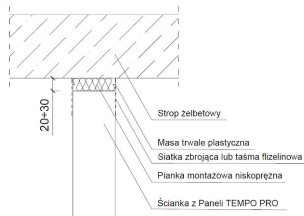
Rys. 3. Schemat wykonania wypełnienia szczeliny podstropowej.
