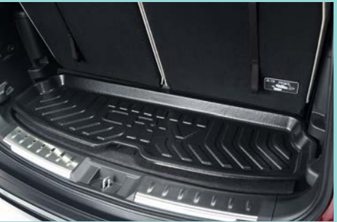
Bac de chargement Le bac de chargement aide à protéger le plancher de l'espace de rangement arrière contre les déversements accidentels pouvant survenir dans les virages serrés et lors des arrêts brusques.
