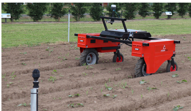
图 2-9 澳大利亚Agerris 公司开发的数字农场助手是正在研发的机器人系统中的一款，它可以自动完成一系列农场管理活动，包括杂草精准治理。 (图片摄于新南威尔士州的Richmond)
