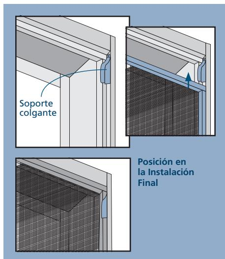
2. Deslice la malla para insertarla en los soportes colgantes (los soportes se pueden rotar ligeramente para permitir que el marco de la malla se inserte). Presione la parte inferior de la malla hacia dentro, hacia el marco de la ventana, hasta que quede contra el tope.
