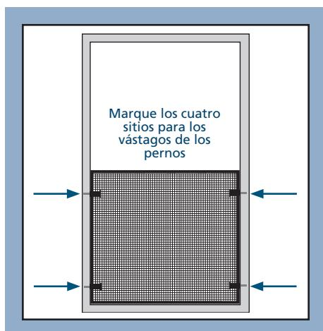
2. Retire la malla y taladre un orificio de 1/4" de diámetro x 1/4" de profundidad en la parte exterior, centrado en el lugar que corresponde al tope, en cada marca.
