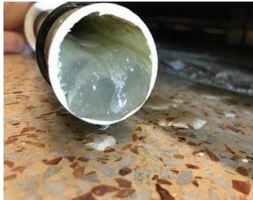
Typische Biofilmentstehung in Kondensatableitungsrohren
