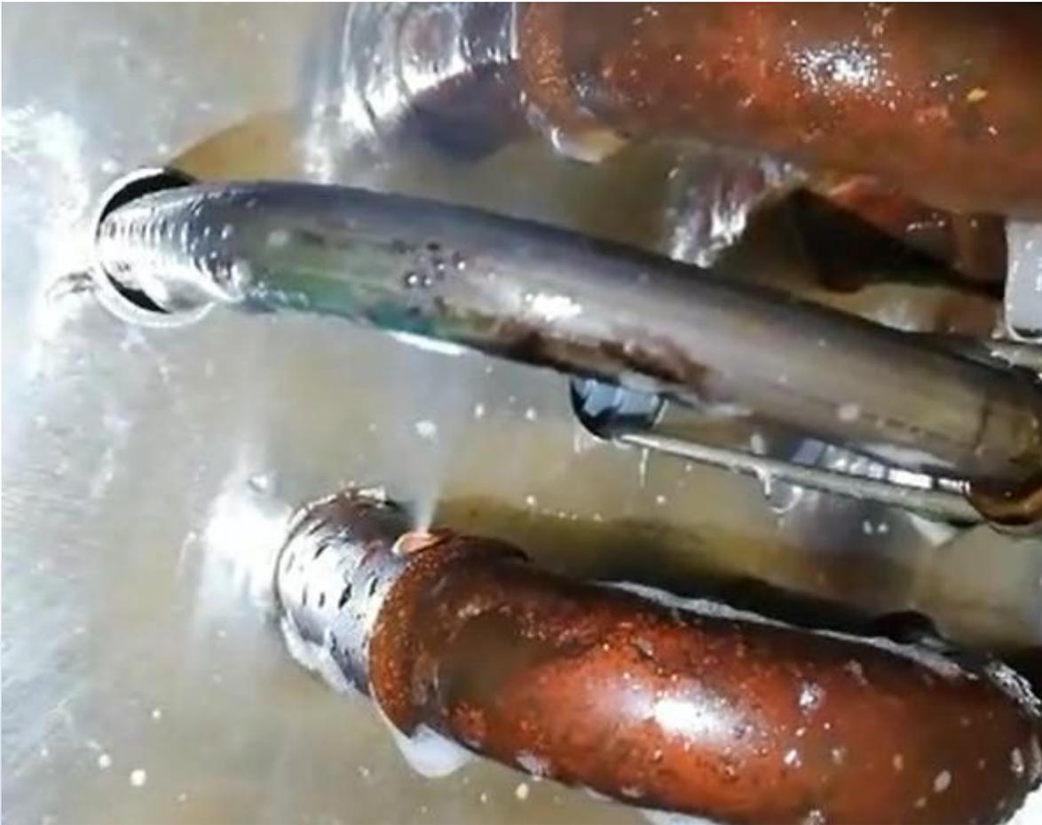
Auffrierung an der Lötnaht
