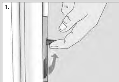
Kantpaskvil til gående post.
