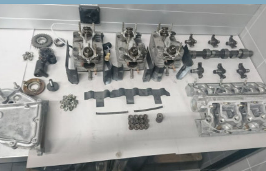
Saubere und penible Auslage der Einzelteile nach erfolgter Motorzerlegung. Die einzelnen Bauteile werden systematisch beurteilt. Danach beginnen die Vorbereitungsarbeiten für den späteren Zusammenbau.
