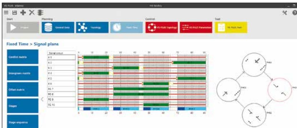
Die Software VS-PLUS eXpress führt den Anwender von der Erstellung der Knotentopologie über die Festzeitsteuerung bis zur fertigen verkehrabhängigen Parametrierung
